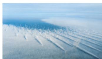
大規模洋上風力発電所の風車後流
