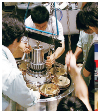
超電導回転機の発電試験
