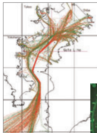
レーダによる船舶動静の計測
