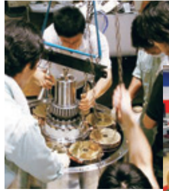
超電導回転機の発電試験
