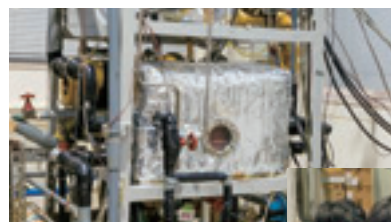
実験用吸収冷凍装置
