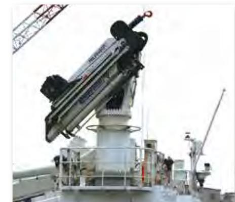
船尾部漁労クレーン Aft fishing crane
