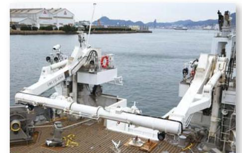
船尾Aフレームクレーン A-frame crane
