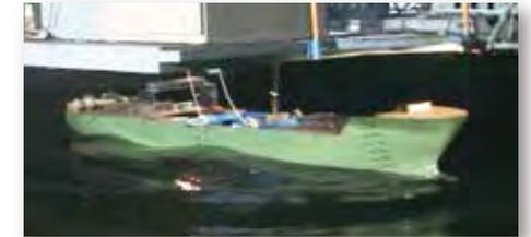
操縦性能試験 Maneuvering test
