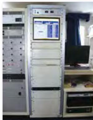
自動気象観測装置 Automatic meteorological observation system
