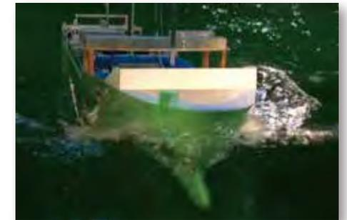
耐航性能試験 Seakeeping test
