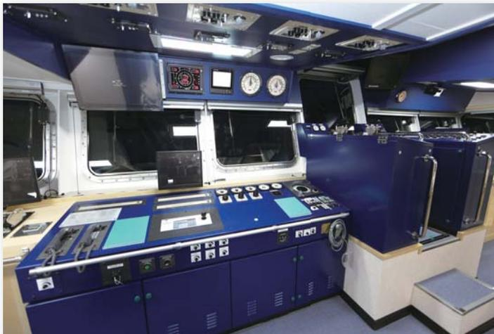
トロールウインチ・観測ウインチ操作区画 Trawl and oceanographic winch operation area
