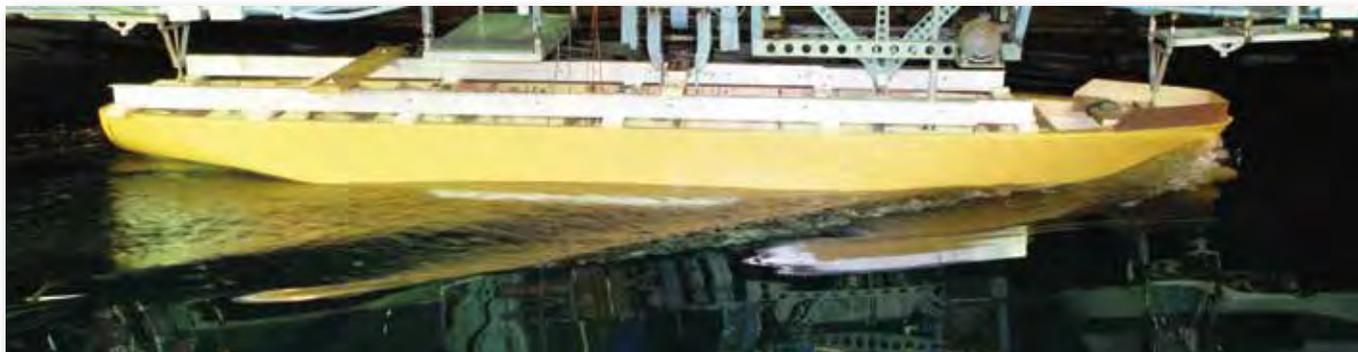
抵抗試験 Resistance test
