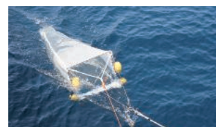
海表面を漂うマイクロプラスチックを採集するニューストンネット Neuston net to sample micro-plastics drifting on the sea surface
