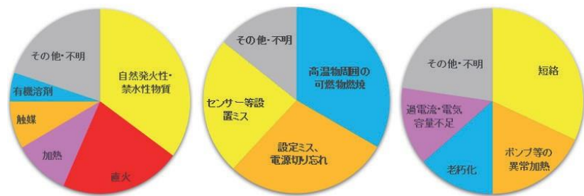
図 1.6 火災の要因（左より薬品取扱・反応、高温物、電気・電子機械）
