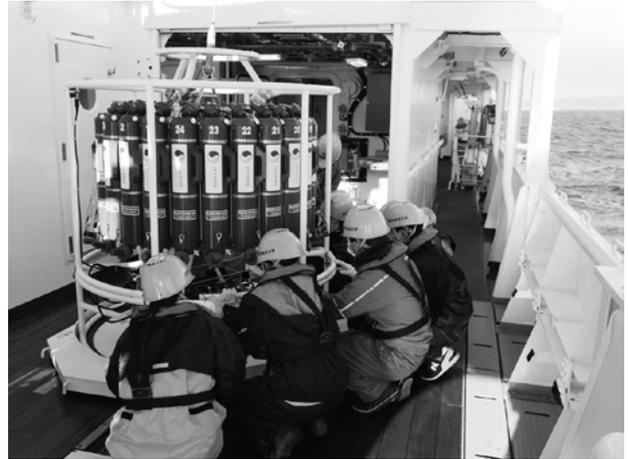
海洋観測に用いる CTD システム（電気伝導度・水温・圧力等を計測するセンサーと採水器）について説明を受ける学生
