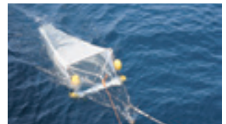
海表面を漂うマイクロプラスチックを採集するニューストンネット Neuston net to sample micro-plastics drifting on the sea surface
