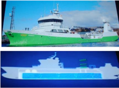
ウェルボートで若魚の運搬・搬入と収穫した成魚の搬出・運搬
