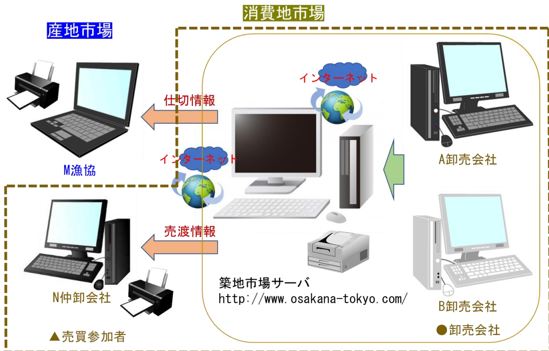
図 3.1.1 水産物流通 EDI ネットワークシステム「マリネット」の概要
