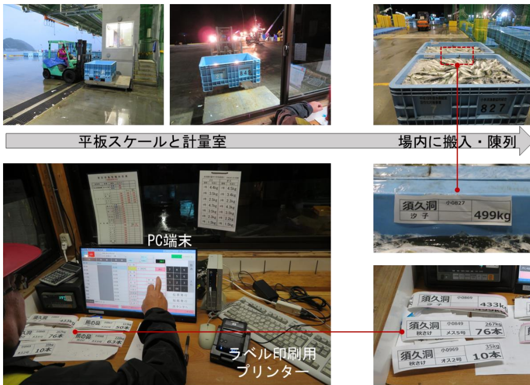
図 3.4 タンク売りの計量(計量室) : 計量・記録・個体管理
