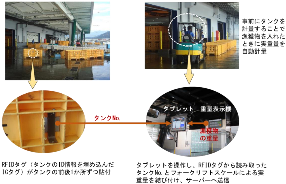
図 3.5 容器の IoT 化とスケール付きフォークリフトによる自動計量および記録 (大船渡市魚市場)
