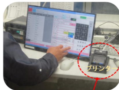
計量ブース内ではタンク番号等を確認し船名、魚種、重量等データをサーバーへ転送
