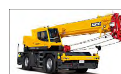
ラフタークレーン
