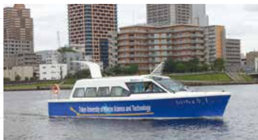
世界初の急速充電対応型電池推進船「らいちょう I」
