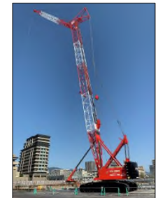
クローラークレーン
