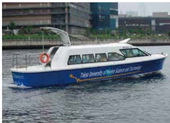
世界初の急速充電対応型電池推進船「らいちょう I」
