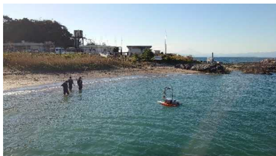
写真1. 荒崎浜にて小型ASVの航走試験
