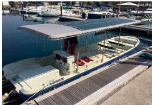
世界初の急速充電対応型電池推進船「らいちょう S」
