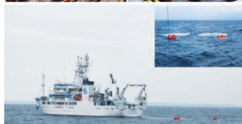
エアガン音源システムによる地震探査観測作業風景
