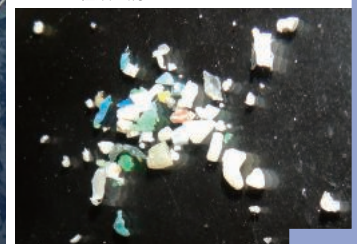
ニューストンネットで採取されたマイクロプラスチック。赤外分光分析でプラスチックの種類を調べる
