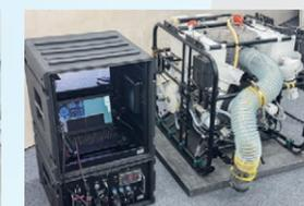
ROV (水中遠隔操縦ロボット)
