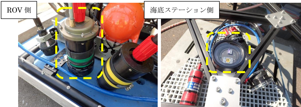
写真3 ROV および海底ステーションに取り付けた光無線通信装置（点線枠内）
