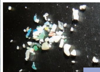
ニューストンネットで採取されたマイクロプラスチック。赤外分光分析でプラスチックの種類を調べる
