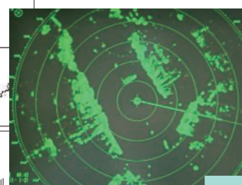
レーダーによる船舶動静の計測
