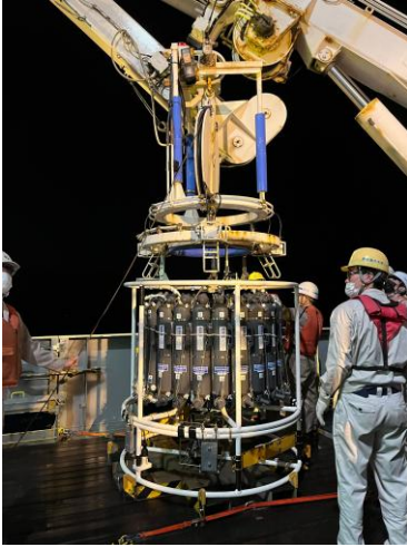
写真 海鷹丸に搭載されている多層採水器
