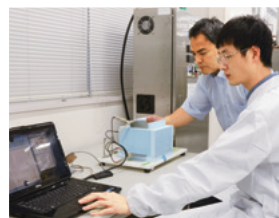
ジュール熱の発生に関わる電気伝導度を測定する様子
